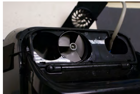
7.2 Reinigen Sie das Laufrad.
